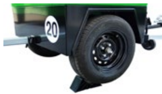
Wheels with tire P175/80 R13. Ruedas con neumático P175/80 R13. Roues avec pneus P175/80 R13.
