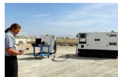
Sergio Frutos realizando las pruebas de medición de emisiones sonoras del equipo IIRN-165
