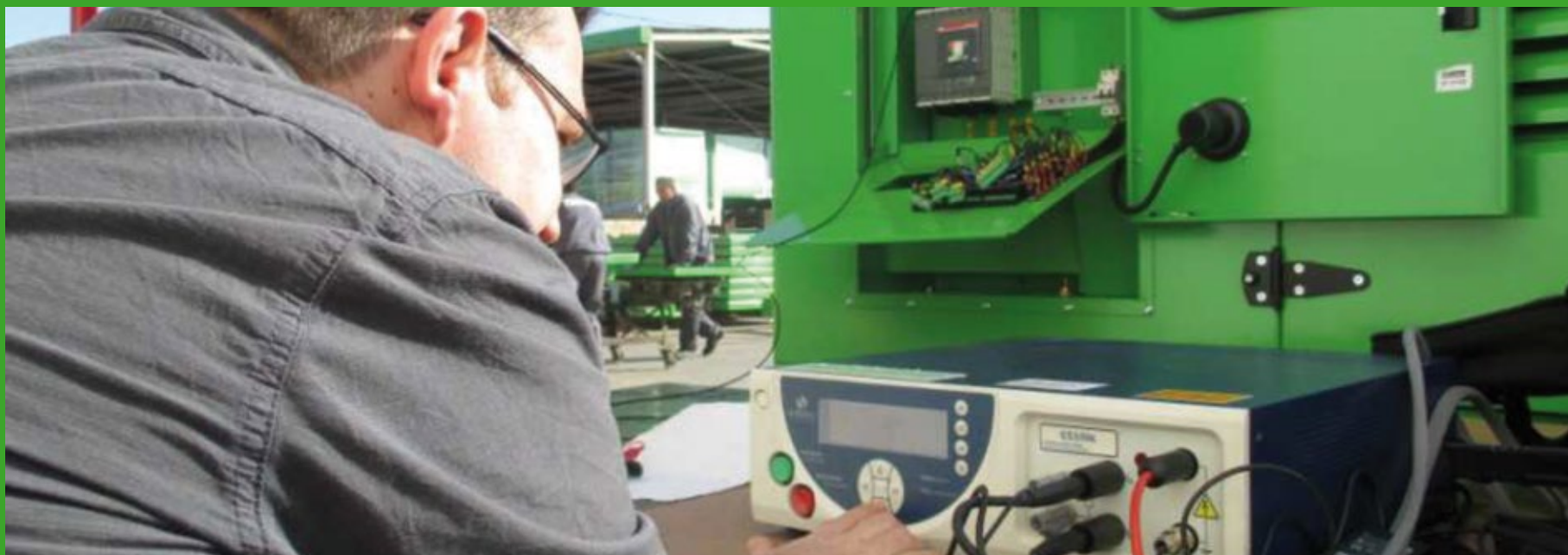
Se aplica una tensión de 500 Vdc utilizando un multímetro digital.
