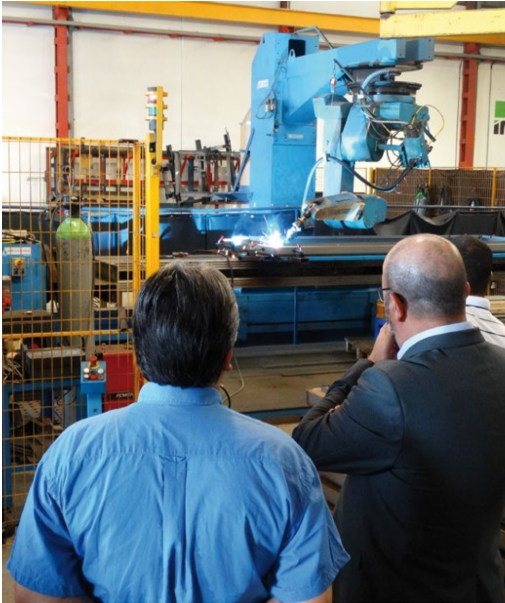
Sección de chapa: Robot de soldadura
